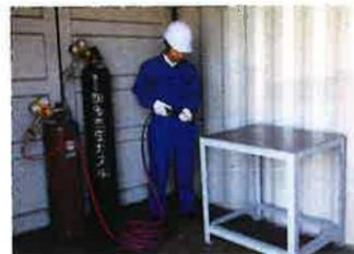
ガス溶接とは、可燃性のアセチレンガスなど可燃性ガスを用い、金属を高温にし接合することをいいます。同様のガスを用いて金属の溶接を行うこともできます。可燃性ガス及び酸素を用いた溶接等作業を行う際に必要な資格です。幅広い分野で使用されています。
